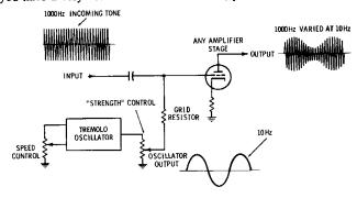
Fig. 2-6. Tremolo circuit.
